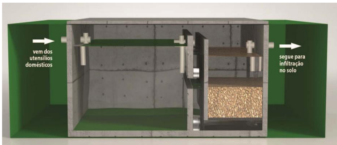
Figura 49 - Esquema de fossa séptica conjugada a filtro anaeróbio.
