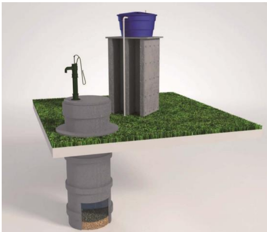
Figura 46 - Esquema de poço escavado com reservatório elevado.
